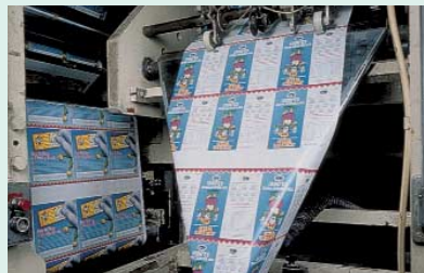
Druckendstufe: Abriebfestigkeit und niedriger Reibungswiderstand von 3M™ UHMW-PE-Klebebändern erleichtern hier den Transport der Papierbahnen über die Ränder.
