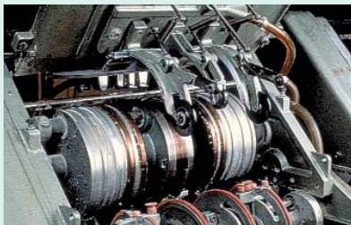
Druckendstufe: An den Druckzylindern dieser Zuführstation erleichtern 3M™ PTFE-Klebebänder durch verringerte Reibung den Durchlauf der Druckerzeugnisse.
