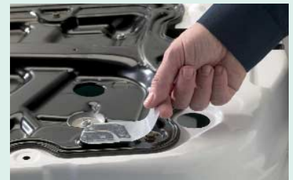
Knarrende und quietschende Geräusche im Auto werden gedämpft, indem 3M™ UHMW-Klebebänder eine „Gleitfläche“ zwischen zwei Substraten bilden.
