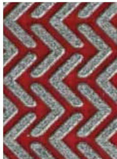
V-förmige (Chevron) Oberflächenstruktur Diamant-Beschichtung für eine erhöhte Kantenfestigkeit.
