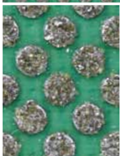
Punktförmige Oberflächenstruktur der Diamant-Beschichtung. Zwei „Pattern-Designs“ bestimmen Korninselgröße und -verteilung.
