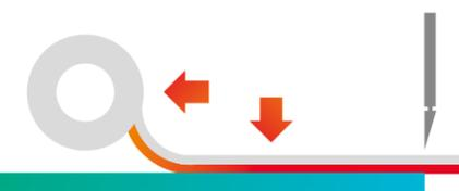
Das Klebeband auf die zu verklebende Oberfläche auflegen, stramm ziehen, aber nicht überdehnen, Lufteinschlüsse vermeiden.
